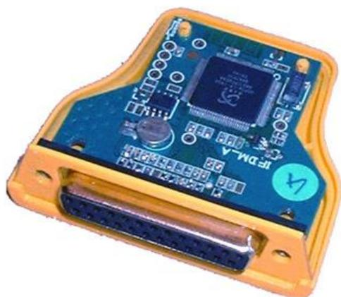
La carte électronique contenue dans la cartouche est une version miniaturisée du produit INFORAD V2 de dernière génération expurgée de son antenne GPS interne et capable d'un fonctionnement direct sur batterie. Un effort tout particulier a été porté sur l'intégration maximale des composants électroniques afin de réduire l'encombrement de l'ensemble.
